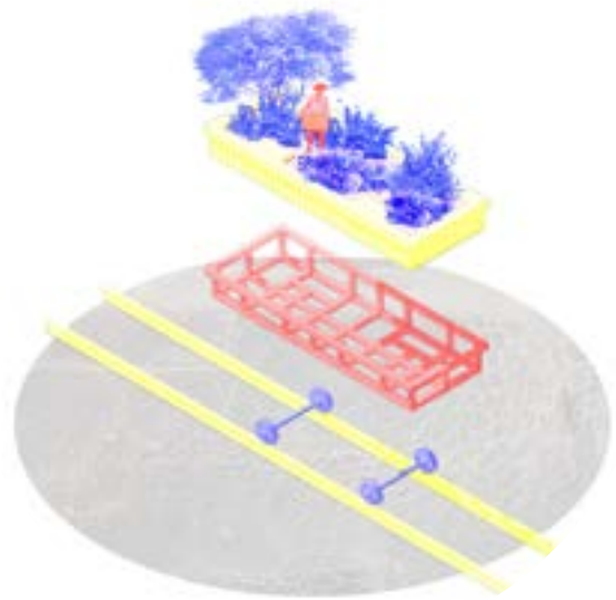
Konstruktion der rollenden Hochbeete
